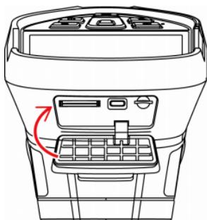
Cerrar la tapa de la ranura y deslizarla en la dirección de la flecha hasta que encaje.
